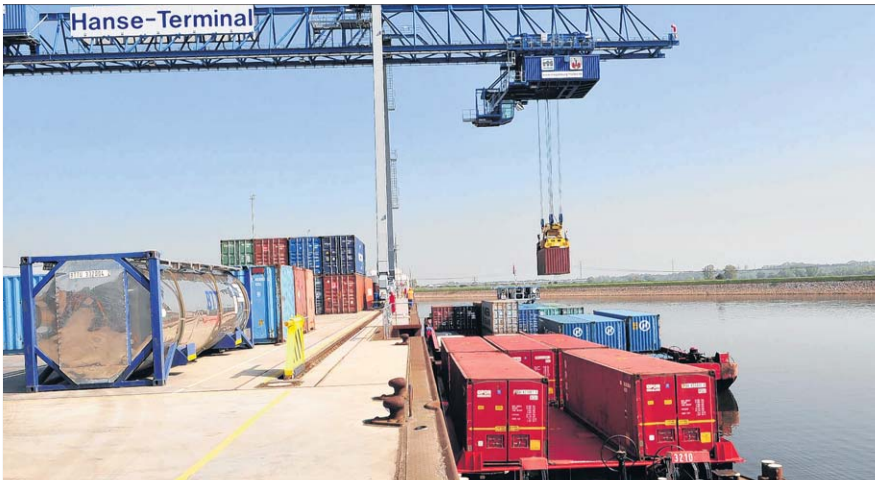
Ein Schubverband lädt in Magdeburger Hafen Container. Die Binnenreederei nutzt diesen Schiffstyp, da die Last auf mehrere „Anhänger“ (Leichter) verteilt werden kann, so dass sie weniger tief ins Wasser tauchen als große Motorgüterschiffe. So sind auch größere Tonnagen auf einem Niedrigwasserfluss wie der Elbe wirtschaftlich möglich. Foto: Uli Lücke
